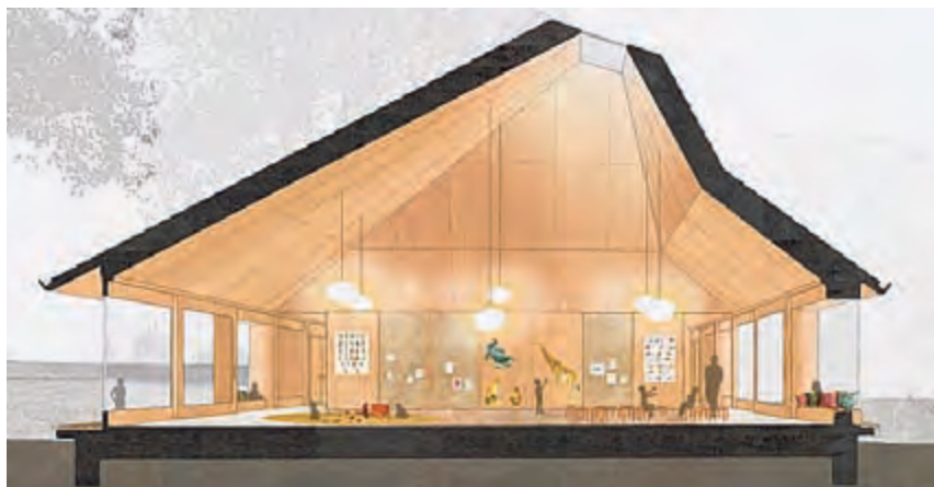
Schnitt durch den geplanten Kindergarten-Pavillonbau an der Paradiesstrasse – unten kommt nun noch ein Kellergeschoss hinzu.
