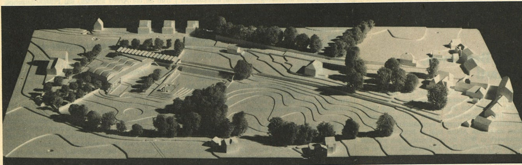
Das Frei- und Hallenbad in der Nordwestecke des La Roche-Areals an der Ecke Weilstrasse/Lörracherstrasse bei der Tramhaltestelle Weilstrasse. Das Gebäude mit Wellendach ist die Schwimmhalle, gleich oben anschliessend die Garderobentrakte (Sheddächer), darunter befindet sich die Eingangshalle mit Kassen, Diensträumen, Restaurant usw. Rechts der Schwimmhalle das Schwimmerbecken des Freibades. Noch mehr rechts das alleinstehende Gebäude die bestehende Sommervilla des La Roche-Areals.
