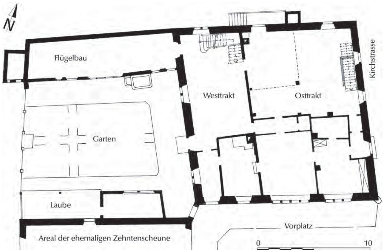
65. Landvogtei, Grundriss des Erdgeschosses (1:200).
