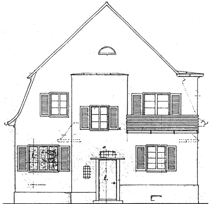
19. / 20. Trauf- und Giebelseite des Wohnhauses Schmiedgasse 7, Baupläne für den Umbau von 1933. Gestrichelt angegeben sind dabei weggefallene ursprüngliche Elemente des Baus von Burckhardt, Wenk & Cie. aus dem Jahr 1911.
