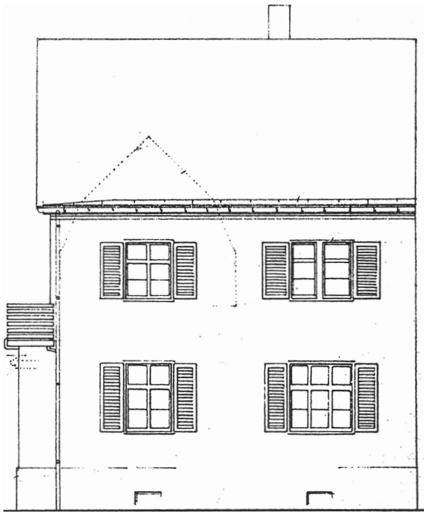
19. / 20. Trauf- und Giebelseite des Wohnhauses Schmiedgasse 7, Baupläne für den Umbau von 1933. Gestrichelt angegeben sind dabei weggefallene ursprüngliche Elemente des Baus von Burckhardt, Wenk & Cie. aus dem Jahr 1911.
